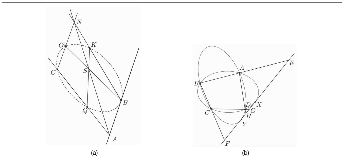
FIGURA 20 – (a) Diagramma per la costruzione della conica per tre punti e tangente ad una retta in un punto assegnato. (b) Illustra il caso delle coniche per quattro punti e tangenti ad una retta assegnati.
