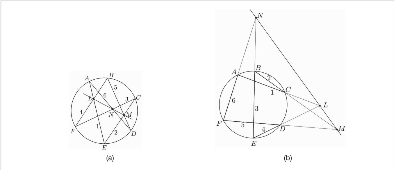
FIGURA 7 – (a) Il diagramma mostra un esagono intrecciato  $AECFBD$  i cui lati opposti 1,4; 2,5, e 3,6 si intersecano in punti allineati  $L, M, N$ . (b) Questo diagramma mostra che unendo i sei punti in modo diverso si ottiene un esagono  $ACBEDF$ , i cui lati opposti 1,4; 2,5; 3,6 si intersecano ancora in tre punti allineati.
