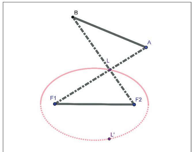
FIGURA 11 – Modello virtuale di ellissografo ad antiparallelogramma.
