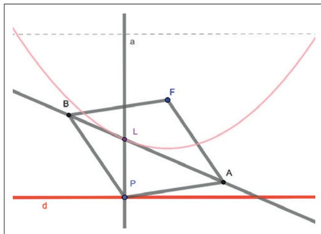
FIGURA 17 – Modello virtuale di parabografo con rombo articolato.
