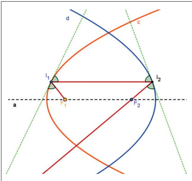
FIGURA 19 – Schematizzazione del funzionamento del doppio specchio parabolico.
