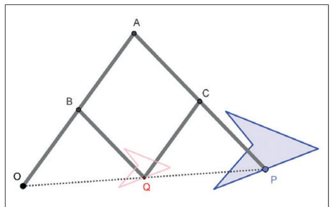
FIGURA 7 – Modello virtuale di pantografo per l’omotetia.
