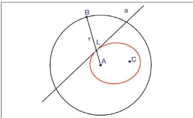
FIGURA 13 – Costruzione di una ellisse mediante un cerchio direttore.
