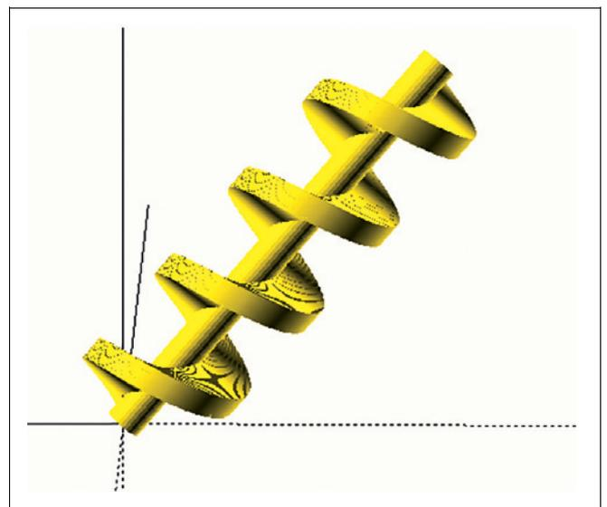
FIGURA 20 – Progettazione 3d di una coclea.
