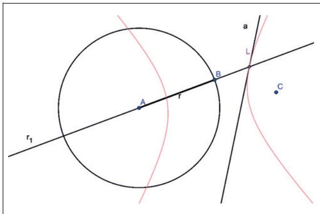
FIGURA 15 – Costruzione di una iperbole mediante un cerchio direttore.
