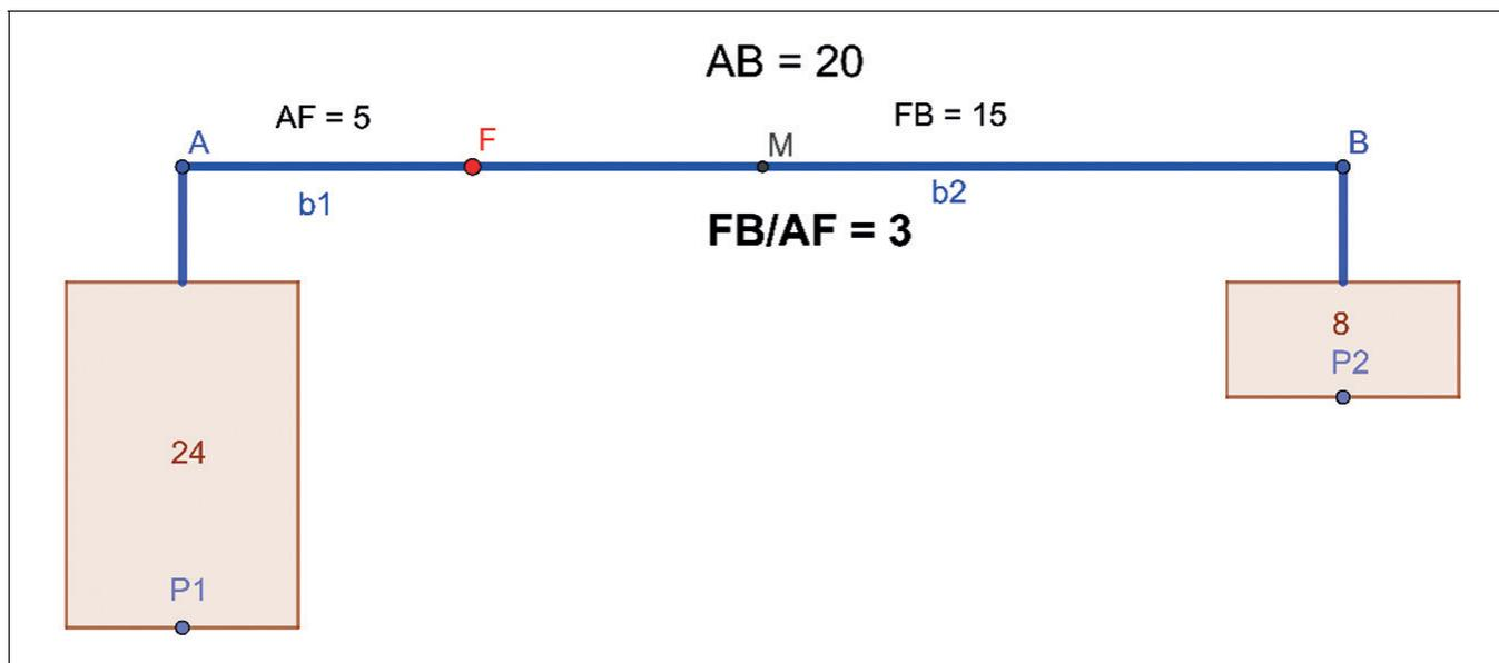
FIGURA 22 – Modello virtuale di una leva.
