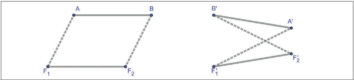
FIGURA 12 – Un parallelogramma e un antiparallelogramma.
