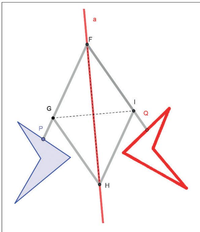
FIGURA 8 – Modello virtuale di pantografo per la simmetria assiale.
