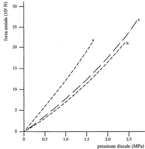
Fig. 2. - Pressione discale dovuto a sollecitazione assiale di compressione del giunto intervertebrale. Curve *a*, *b*, Nachemson [21] quali valori minimo e massimo; curva *c*, risultati del modello proposto.
