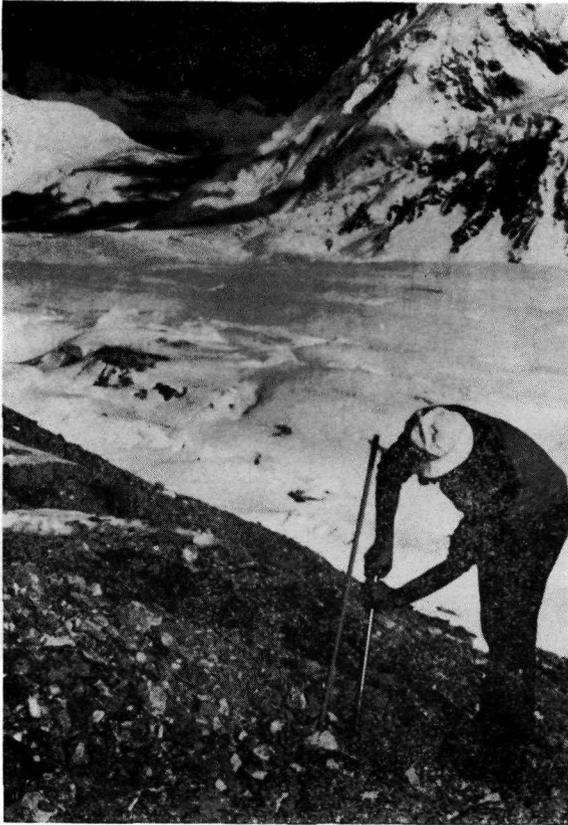
a) Perforazione del ghiaccio mediante trivella a mano nei pressi del campo base per l'inserimento delle paline. Sullo sfondo è visibile la Sella Conway, m 5.973 (foto G.C. Corbellini - Quota 8.000).
