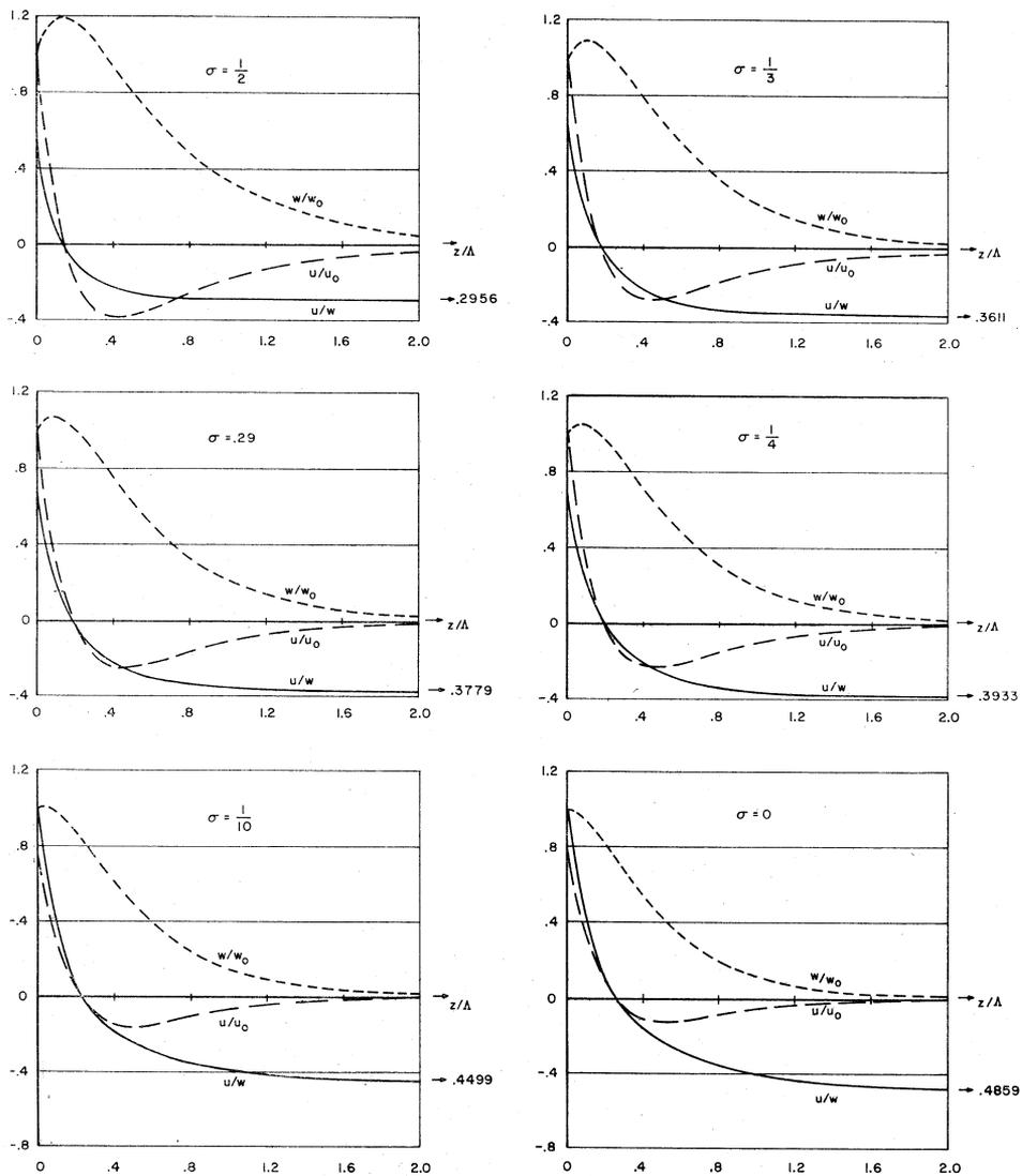
Fig. 2. - Variazione delle componenti dello spostamento e del loro rapporto con distanza dalla superficie.
