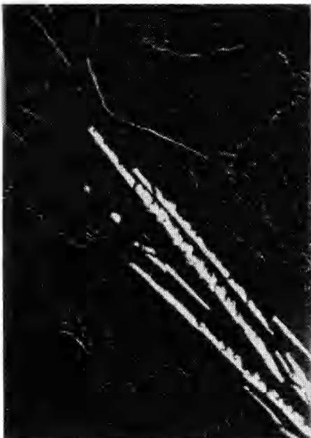
Fig. 3. - Lega allo 0,85 at% Rh (lega N. 2), attacco aria (Al scuro). 250 X.
