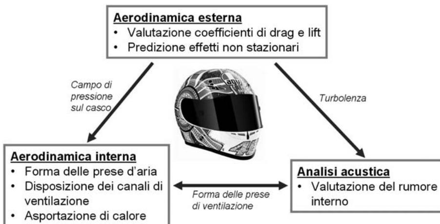
Fig. 1. – Differenti tipi di analisi che possono essere ottenute con la Fluidodinamica Computazionale (CFD).
