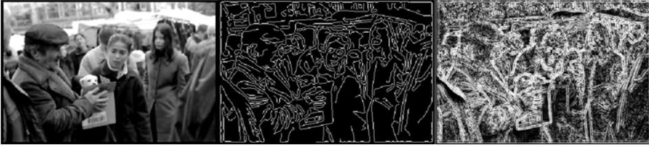
Fig. 9. – Estrazione di zone di interesse. (a) immagine di ingresso; (b) estrazione dei bordi mediante l'algoritmo di Canny [14]; (c) estrazione delle simmetrie locali [15].
