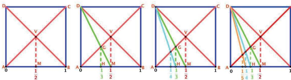
Fig. 4: Determinazione posizione di  $\frac{1}{3}, \frac{1}{4}, \frac{1}{5}, \dots$  del segmento unitario.
