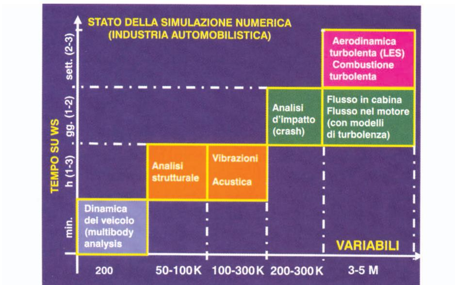
Fig. 10. – Complessità della simulazione numerica nell'industria automobilistica.
