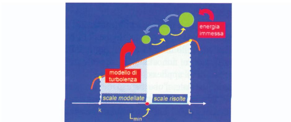
Fig. 9. – Scale risolte e scale modellate nella simulazione di flussi turbolenti.
