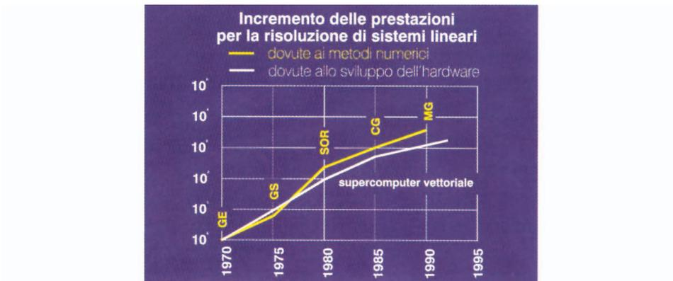
Fig. 12. – *Fattore di guadagno nel tempo di calcolo per la risoluzione di sistemi lineari: dal metodo di eliminazione di Gauss (GE) al metodo multigrid (MG).*
