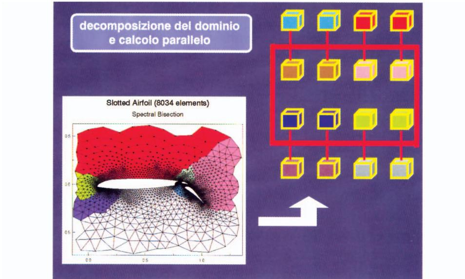
Fig. 11. – *Decomposizione del dominio all'esterno di un profilo alare e calcolo parallelo.*
