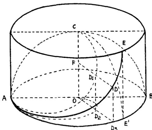
Se tracciamo da  $D_1$  la perpendicolare  $D_1D_2$  alla base della semisfera, abbiamo che quando  $D_1$  percorre l'elica sferica,  $D_2$  descrive una spirale nel piano di base.
